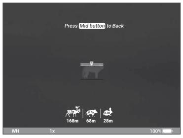
FIGURE 2-9. STADIAMETRIC RANGEFINDER
